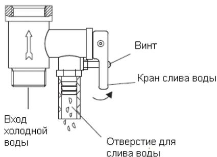
Во избежание поломки при завинчивании предохранительного клапана не применяйте больших усилий.
