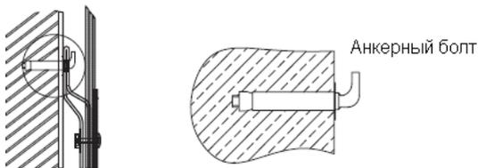
4. При установке анкерных болтов должны быть задействованы все точки крепления, предусмотренные конструкцией водонагревателя. Не допускается подвеска прибора на два анкерных болта, если конструкцией предусмотрены четыре точки крепления
